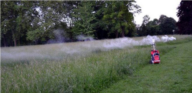
Foto: Sichtbarmachung einer Kaltluftströmung mit paralleler Messung
